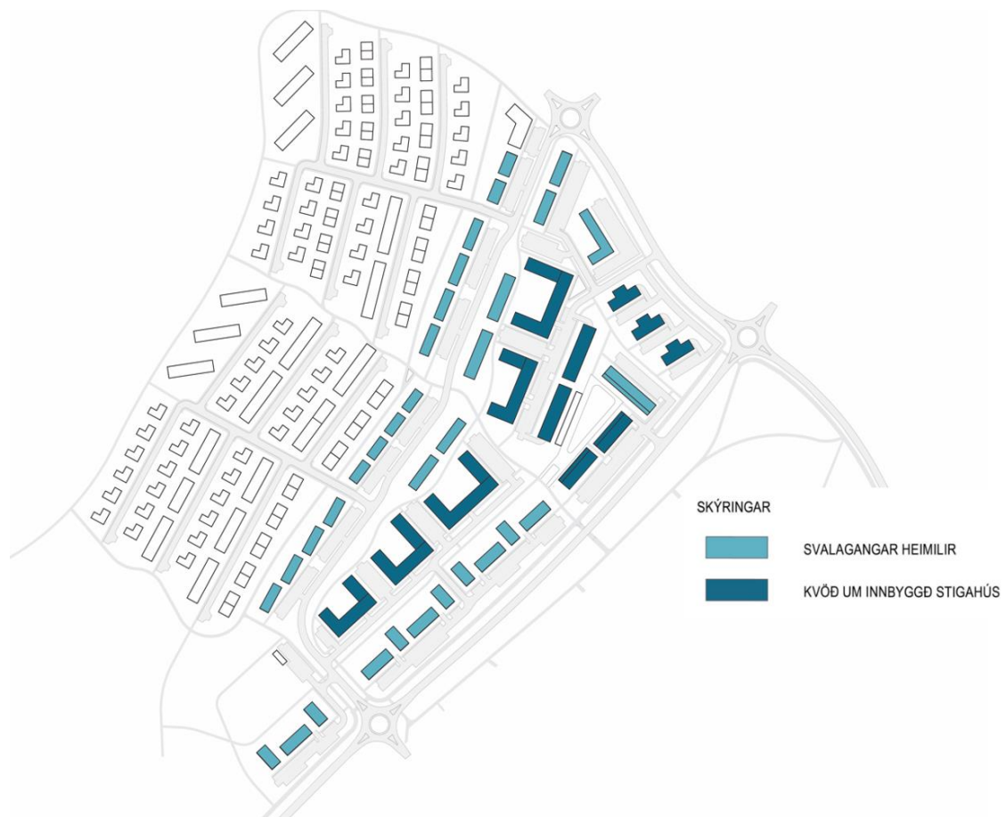
Mynd 7. Stigahús og svalagangar fjölbýlishúsa
